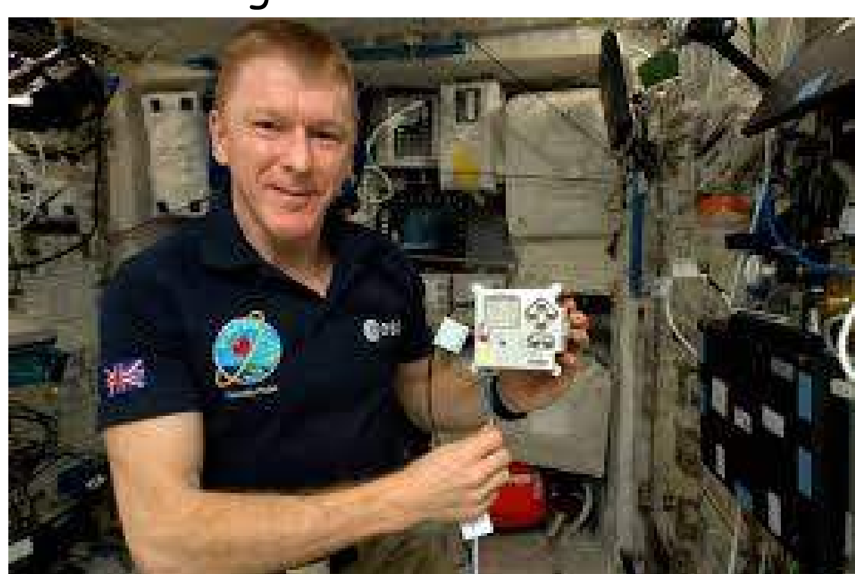
Fig.2: Apparato sperimentale a bordo della ISS: Raspberry Pi e scheda con sensori Sense-Hat e telecamera nel vicino infrarosso
