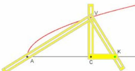
Lungo un binario rettilineo AK in un piano  $\pi$  scorre un segmento CK di lunghezza  $p$  prestabilita. Quando l'angolo retto KCV si muove, trascina con sé un altro angolo retto AVK fisso che ha i lati VA e VK costretti a passare, rispettivamente, per i punti A e K.
