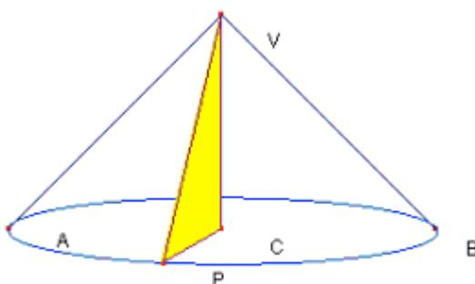
Quando un triangolo rettangolo ruota intorno ad un cateto fissato fino a ritornare alla posizione da cui era partito, la figura così racchiusa è un **CONO**.
